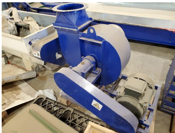
Item 7 Blower Fan Blower fan for transporting material 15kW
